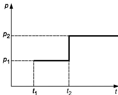
$p_1$  — давление пуска;  $p_2$  — рабочее давление;  $t_1$  — минимальная температура воздуха, при которой допускается пуск сосуда под давлением  $p_1$ ;  $t_1$  — минимальная температура, при которой сталь и ее сварные соединения допускаются для работы под давлением  $p_2$ .
